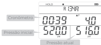
Fig.5 Início da interface de teste de vazamento de pressão
