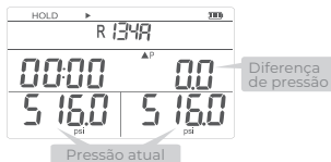
Fig.6 Pausa na interface de teste de vazamento de pressão
